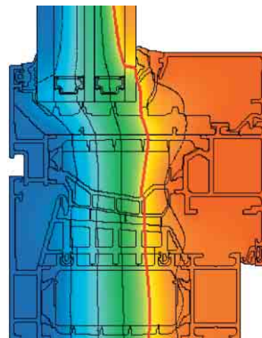
Schüco Fenster AWS 90.SI+, Maßstab 1:2 Schüco Window AWS 90.SI+, Scale 1:2
